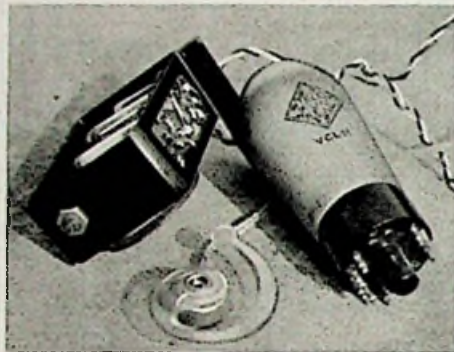
Abb. 7. Der Empfänger ist in das Gehäuse eines Sperrkreises eingebaut. Im Vordergrund der „Dimafon“-Kopfhörer; rechts eine VCL 11 zum Größenvergleich
